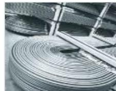
U-Rohre für Wärmetauscher
