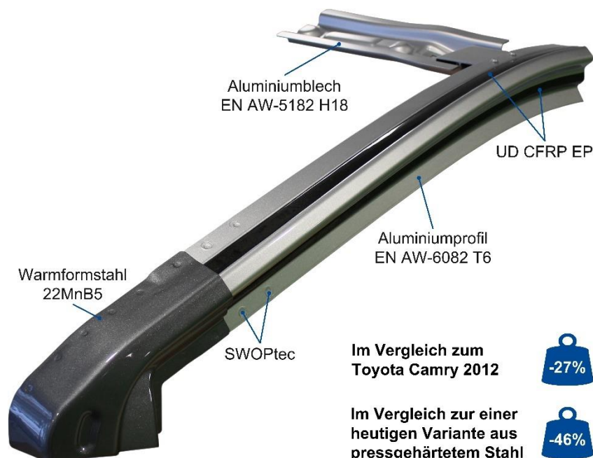
Bild 4 Demonstrator einer Baugruppe in Hybridbauweise (© BAT, LiA)
